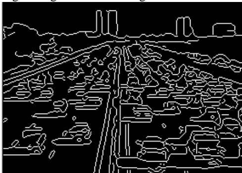
Fig 5 : Canny edge detection
