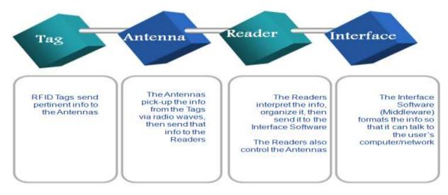
Fig: 1 RFID Components
