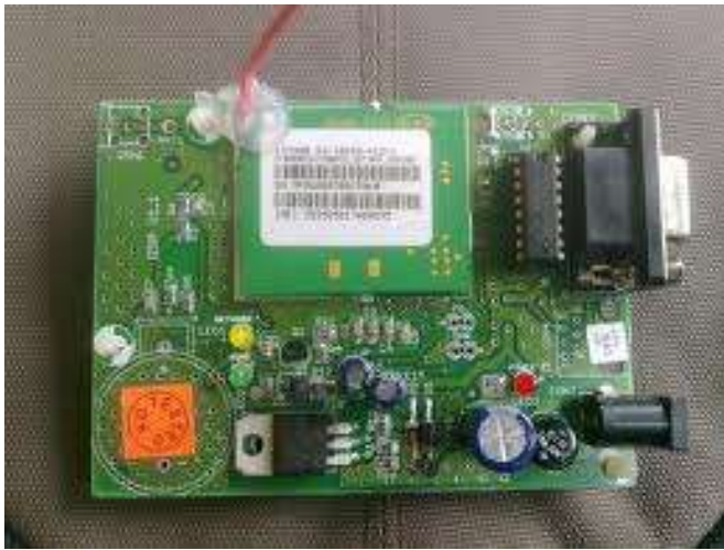
Fig. 3: SIM 300S GSM Module
