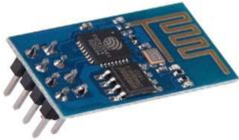
Fig.4. ESP8266 Wi-Fi module
