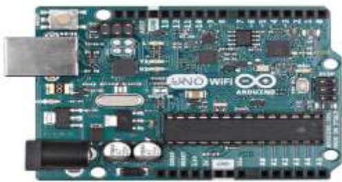
Fig.5. Arduino UNO Wi-Fi board
